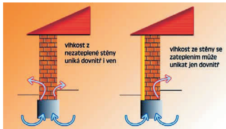
Nevhodné zateplení spodní části zdi izolantem s vysokým difuzním odporem. © EkoWATT
