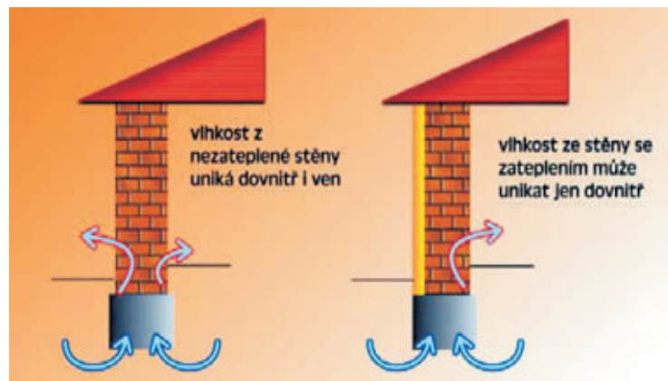
Nevhodně zateplení spodní části zdi izolantem s vysokým difuzním odporem. © EkoWATT
