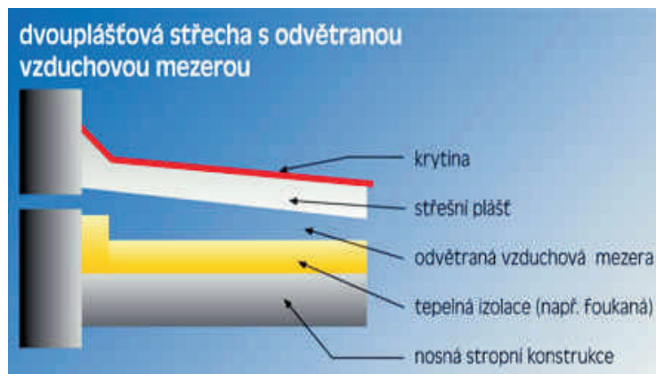
Zateplování dvouplášťové střechy s odvětranou mezerou. © EkoWATT
