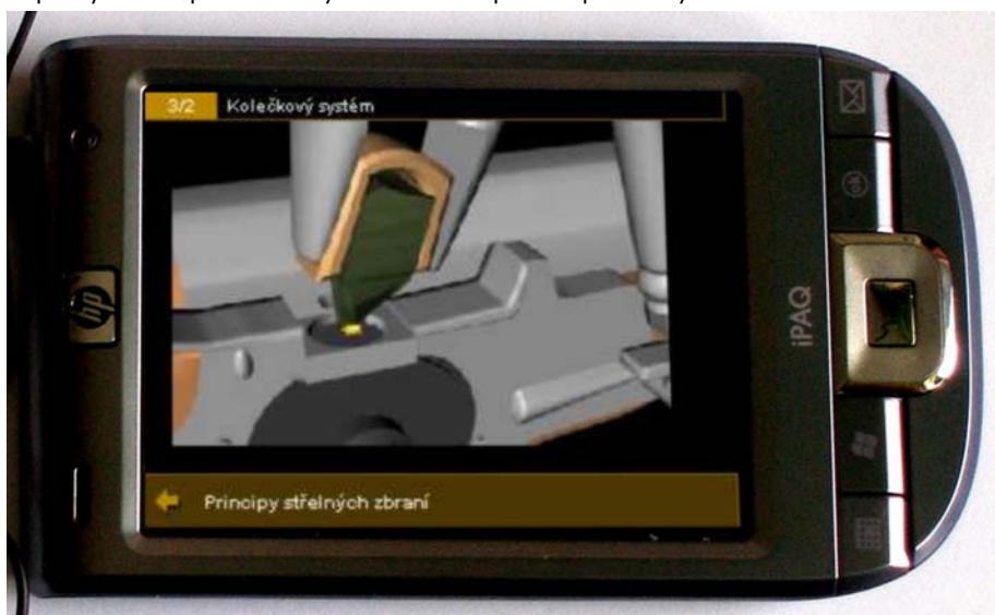
Ukázka animované vizualizace v 3D procesu výstřelu ze střelné zbraně s kolečkovým zápalným mechanismem.
